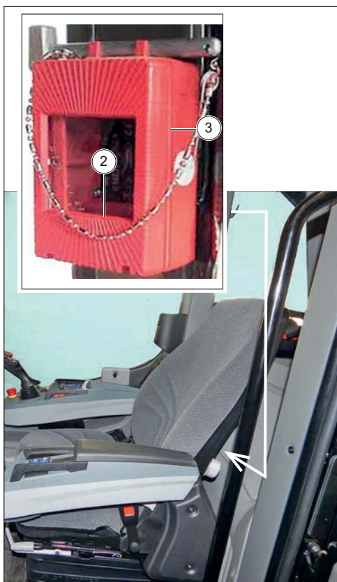
Figure 106: Coffret de sécurité
