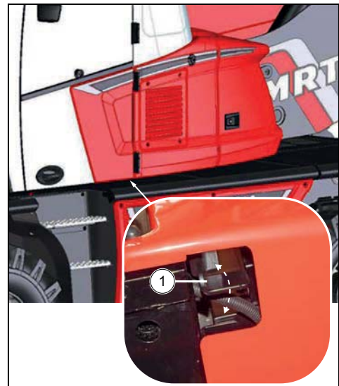
Figure 60: Levier d'ouverture de la vitre de la porte depuis l'extérieur de la cabine
