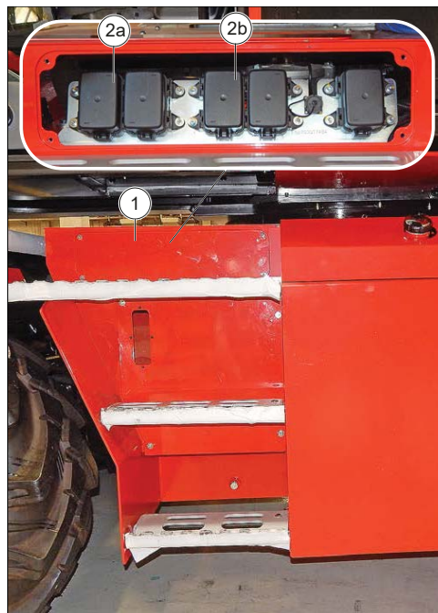
Figure 202: Fusibles et relais sur le châssis
