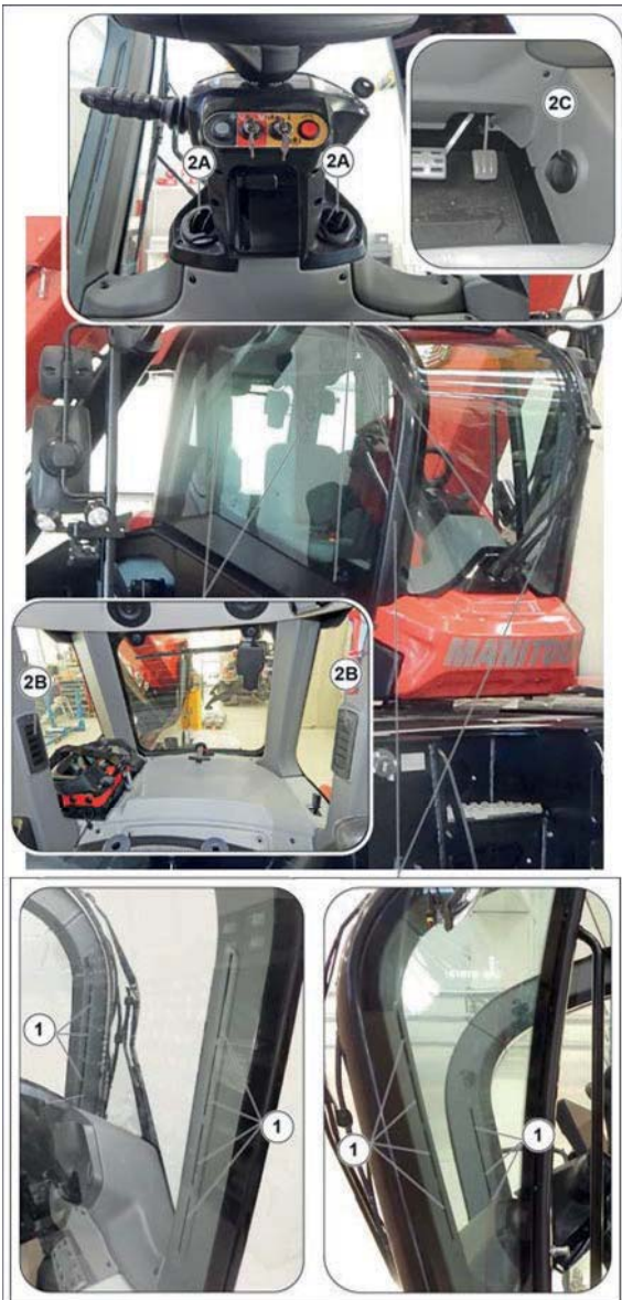
Figure 61: Diffuseurs de désembuage et bouches d'aération du chauffage
