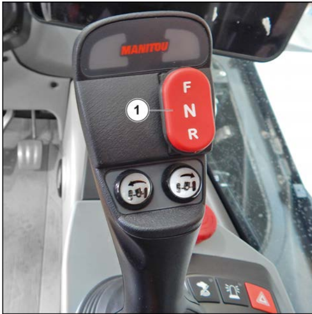
Figure 132: Utilisation du sélecteur FNR
