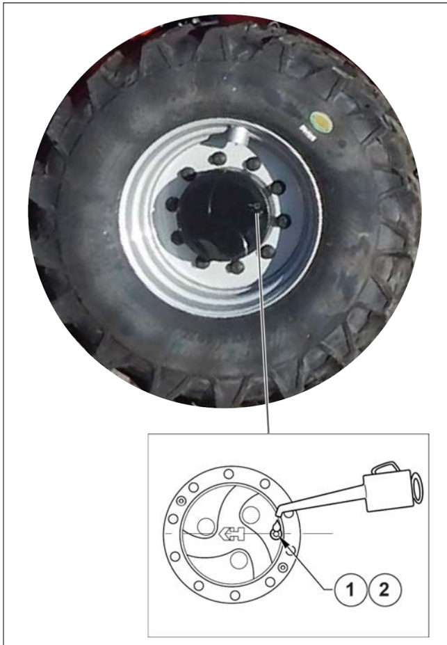
Figure 162: Vérification du niveau d'huile des réducteurs de roues avant et arrière
