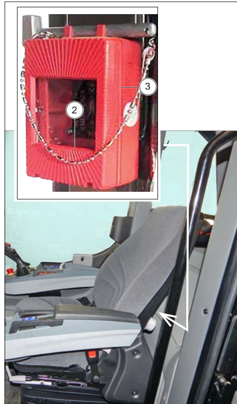
Figure 105: Coffret de sécurité
