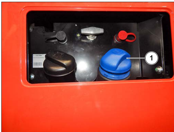
Figure 122: Remplissage du réservoir de DEF
