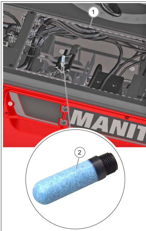
Figure 205: Remplacement du reniflard du réservoir de « DEF »
