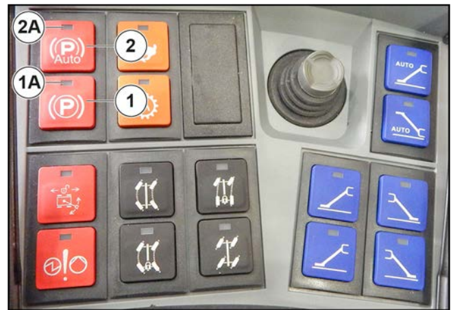
Figure 130: Utilisation du frein de stationnement
