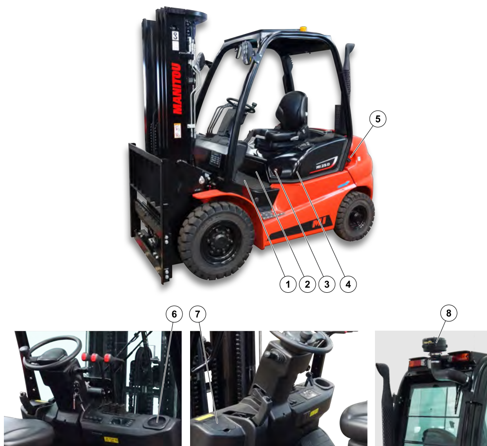
Figure 34: Emplacement des composants de maintenance - MI 20→35 D K ST5 S1
