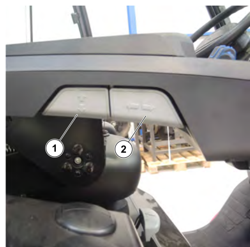
Figure 24: Boutons de réglage de l'accoudoir
