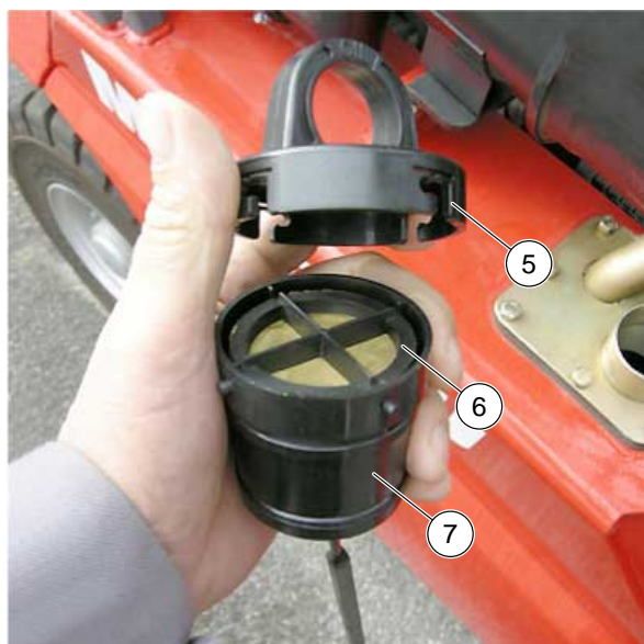
Figure 87: Nettoyage du bouchon du filtre
