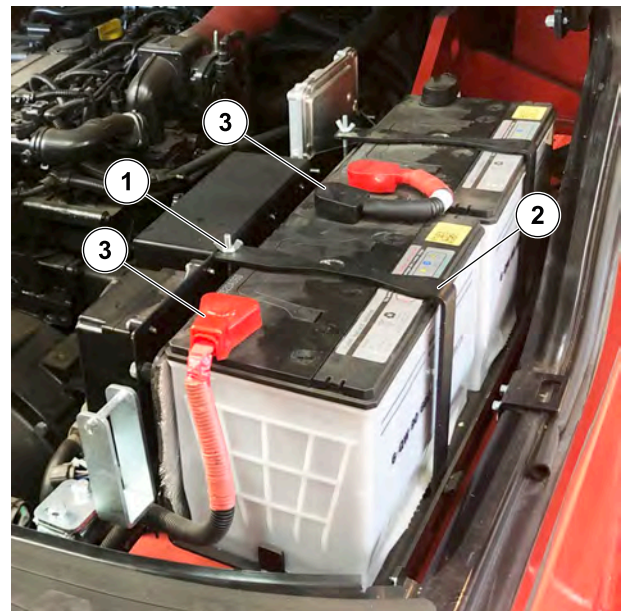
Figure 96: Remplacement des batteries
