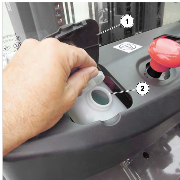
Figure 57: Couvercle d'accès et orifice de remplissage
