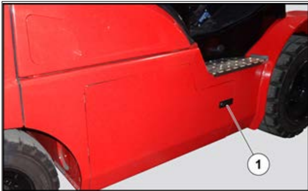
Figure 56: Porte latérale du bac à batteries
