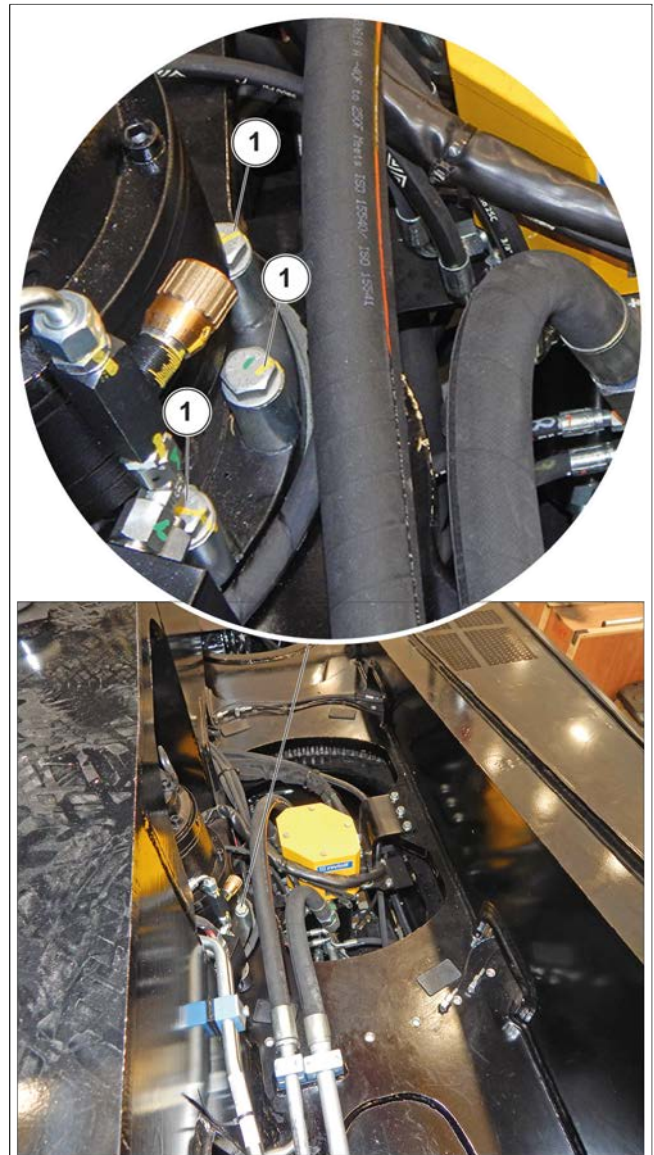
Figure 166: Vérification du serrage de la vis de fixation du réducteur de rotation
