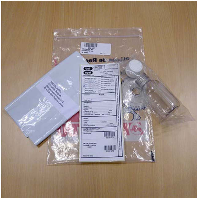
Figure 173: Vérification de la contamination de l'huile hydraulique
