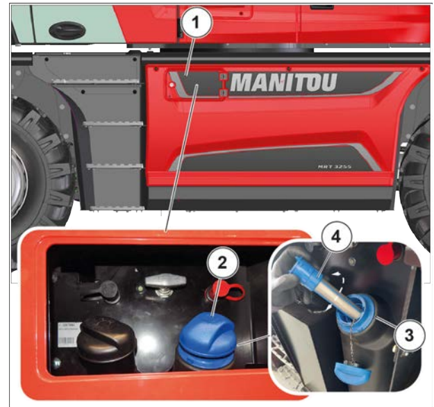
Figure 226: Vérification et nettoyage du filtre de remplissage du réservoir de DEF
