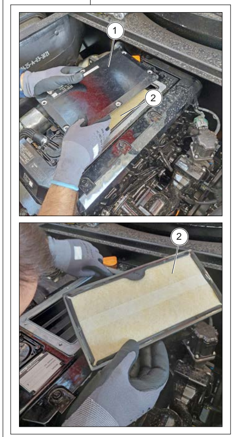
Figure 209: Remplacement du filtre du carter du reniflard du moteur
