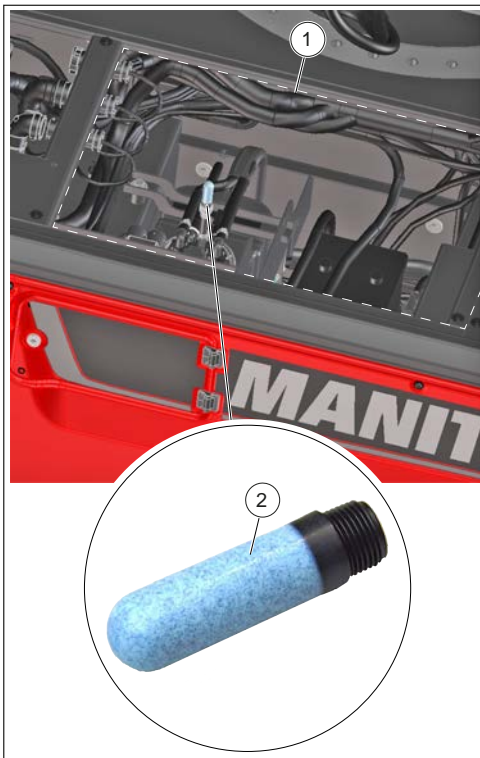
Figure 205: Remplacement du reniflard du réservoir de « DEF »
