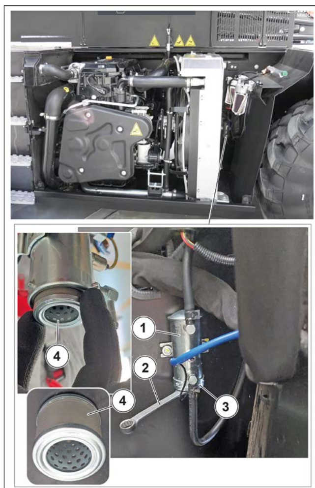
Figure 190: Remplacement du filtre de la pompe à carburant
