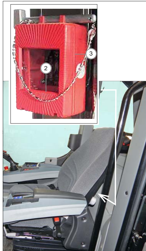
Figure 105: Coffret de sécurité
