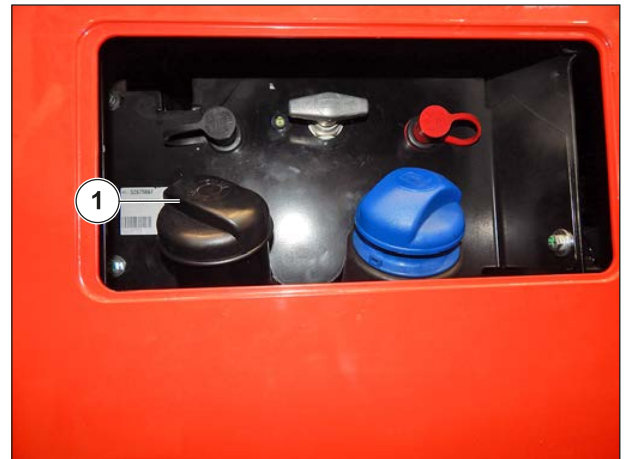
Figure 121: Remplissage du réservoir de carburant
