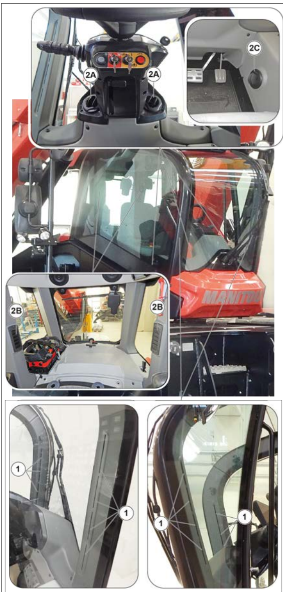
Figure 62: Diffuseurs de désembuage et bouches d'aération du chauffage
