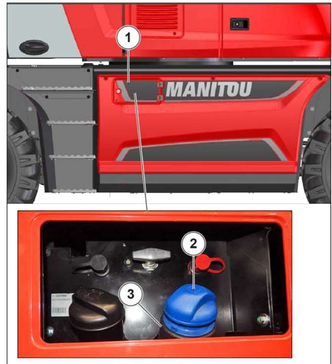
Figure 149: Vérification du niveau de liquide DEF
