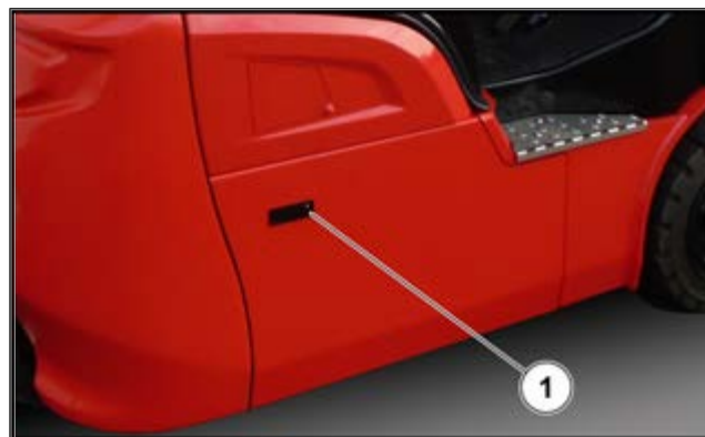
Figure 74: Porte latérale du bac à batteries
