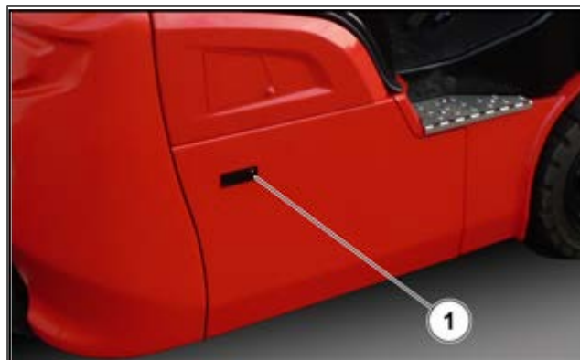
Figure 51: Porte latérale du bac à batteries
